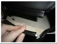
差し込み部を内側に折り込んだ状態で|赤枠内がプラスチック製フック部です。 す。
